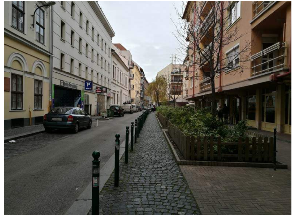
Egyirányú Holló utca keresztmetszeti kialakítása: kétoldali járda, aszfalt útfelület, kockakő parkolósáv, gránit kiemelt útszegély, felállást gátló pollersor
