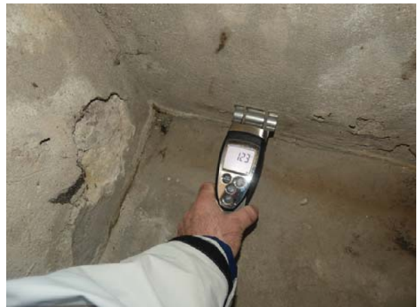
14. kép: Földszint, lépcsőház, erősen nedves szerkezet
