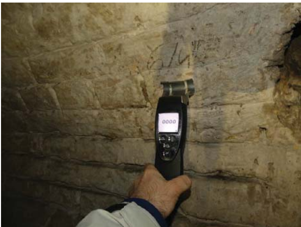
13. kép: Pincefal, telített szerkezet
