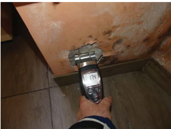
15. kép: Földszint 2. lakás, erősen nedves szerkezet
